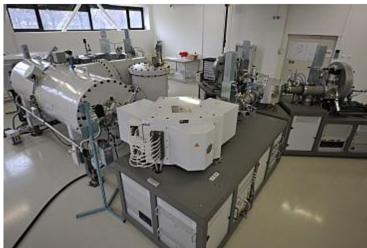
Instalația AMS Tandetron de 1 MV de la DFNA – IFIN-HH
